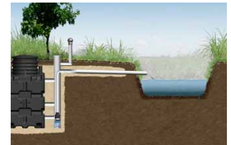
Schematische Darstellung des umgebungsabhängigen Abwasserabflusses mit einfacher Hebe-Pumpe (oben) oder völlig stromlos (unten)
