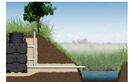
Schematische Darstellung des umgebungsabhängigen Abwasserabflusses mit einfacher Hebe-Pumpe (oben) oder völlig stromlos (unten)
